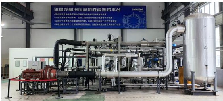
Emaging Maglev Ref Comp Test Loop 磁悬浮制冷压缩机性能测试平台 (中国制冷空调行业试验装置评定合格证书GMPI B级)
