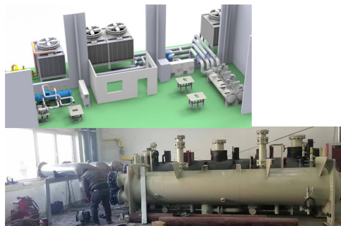
100~1000RT Operating Test Loop 100~1000RT磁悬浮制冷压缩机出厂测试平台 (500RT*2建设中)
