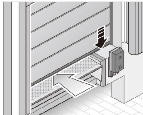
装卸平台直接装在门的下方, 常年
