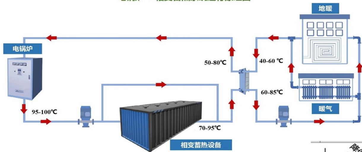
电锅炉 + 相变蓄热系统运行原理图
