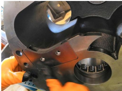
排气端面脉动衰减装置
