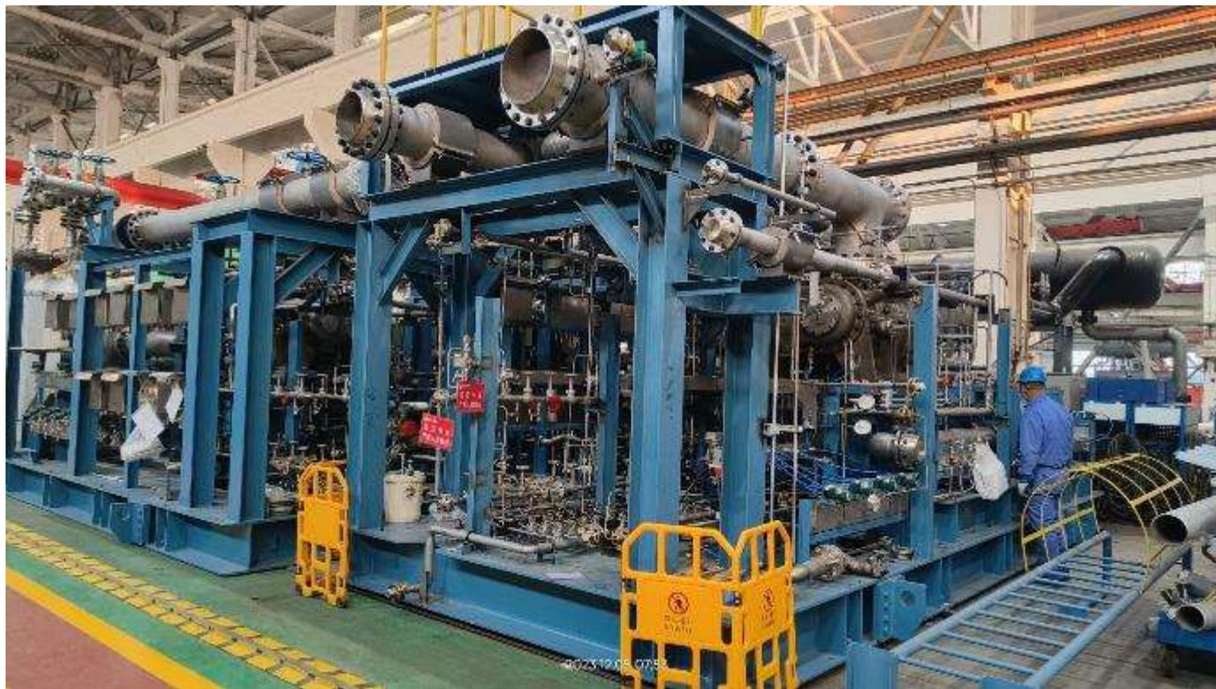
采用2台大容量水蒸气螺杆高温热泵机组，将来自蒸发器的38.9t/h水蒸气压缩到0.9MPa去冷凝器冷凝，**制热COP=9.1**
